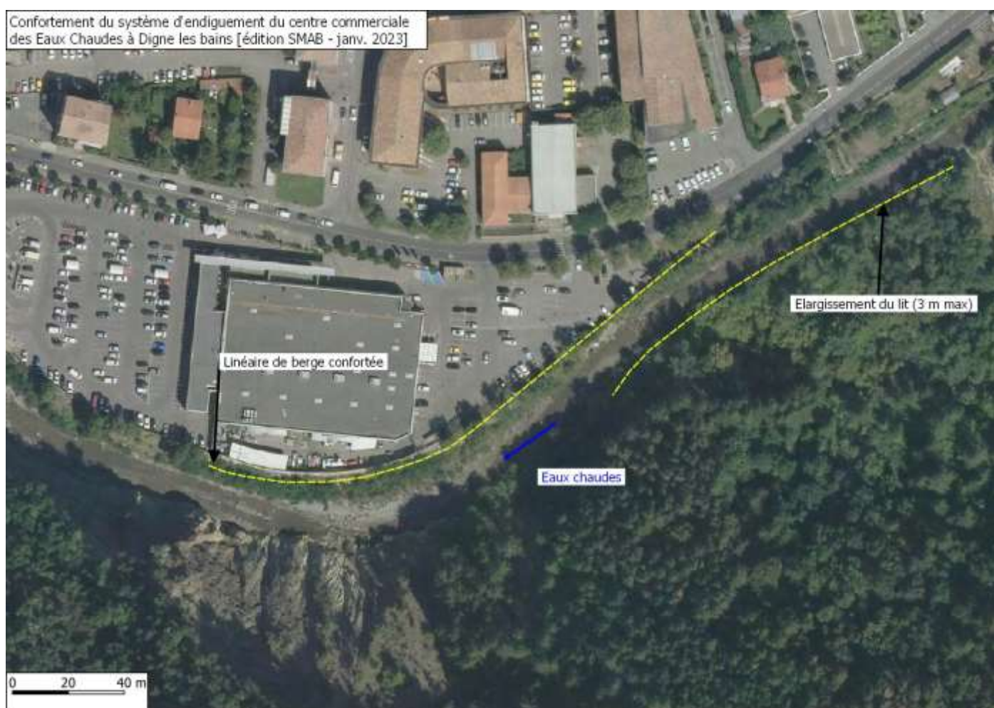
Figure 19 : Localisation des linéaires de travaux sur photo aérienne
