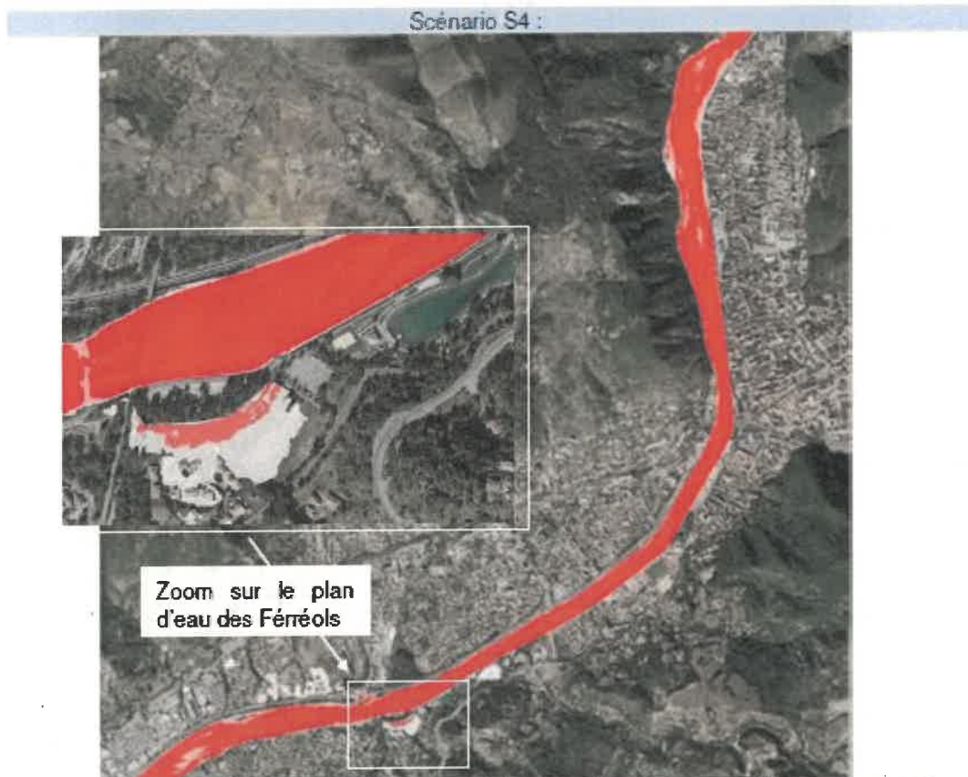
Figure 35 : Zones dangereuses (rouge foncé et rouge clair) et zones non dangereuses (blanc) – scénario S4.
