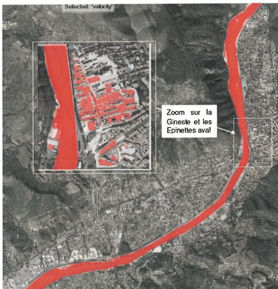
Figure 39: Zones dangereuses (rouge foncé et rouge clair) et zones non dangereuses (blanc)– scénario S7.
