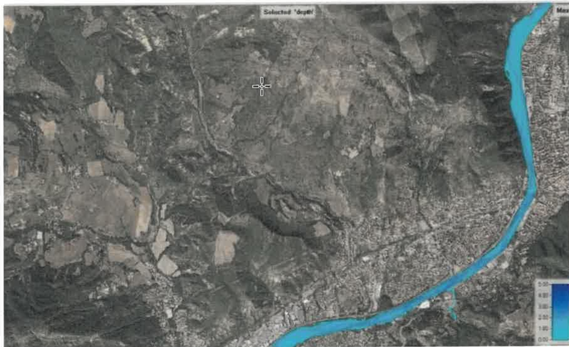
Figure 28: Hauteurs d'eau maximales (m) dans le scénario 9 avec une crue décennale sur la Bléone
