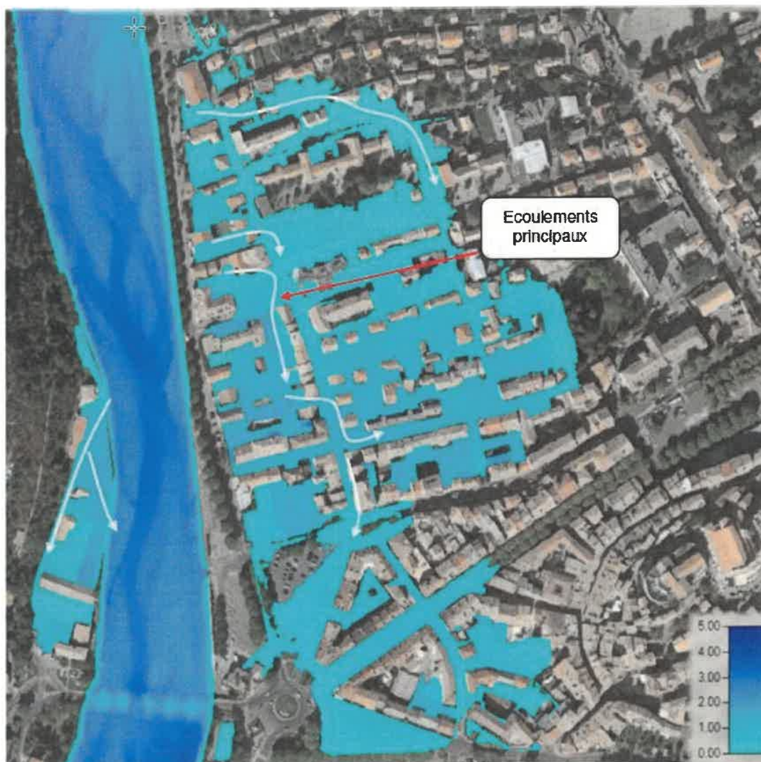
Figure 22: Hauteurs d'eau maximales en mètres et écoulements principaux sur les débordements amont du scénario 7.
