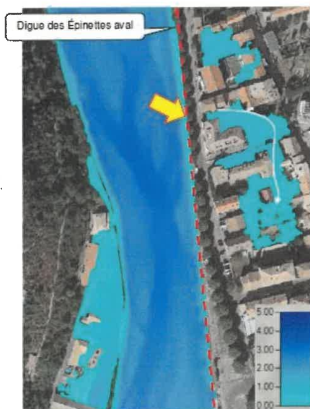
Figure 11 : Hauteurs d'eau maximales en mètres pour un débit de 674 m 3 /s au droit de la digue des Epinettes aval.
