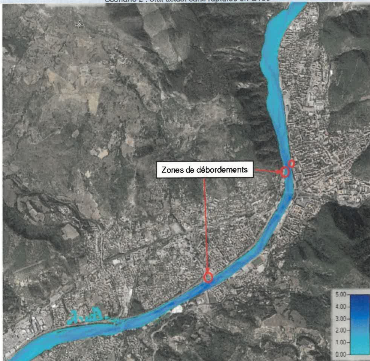
Figure 9 : Scénario 2 : hauteurs d'eaux maximales en mètres – Q100.
