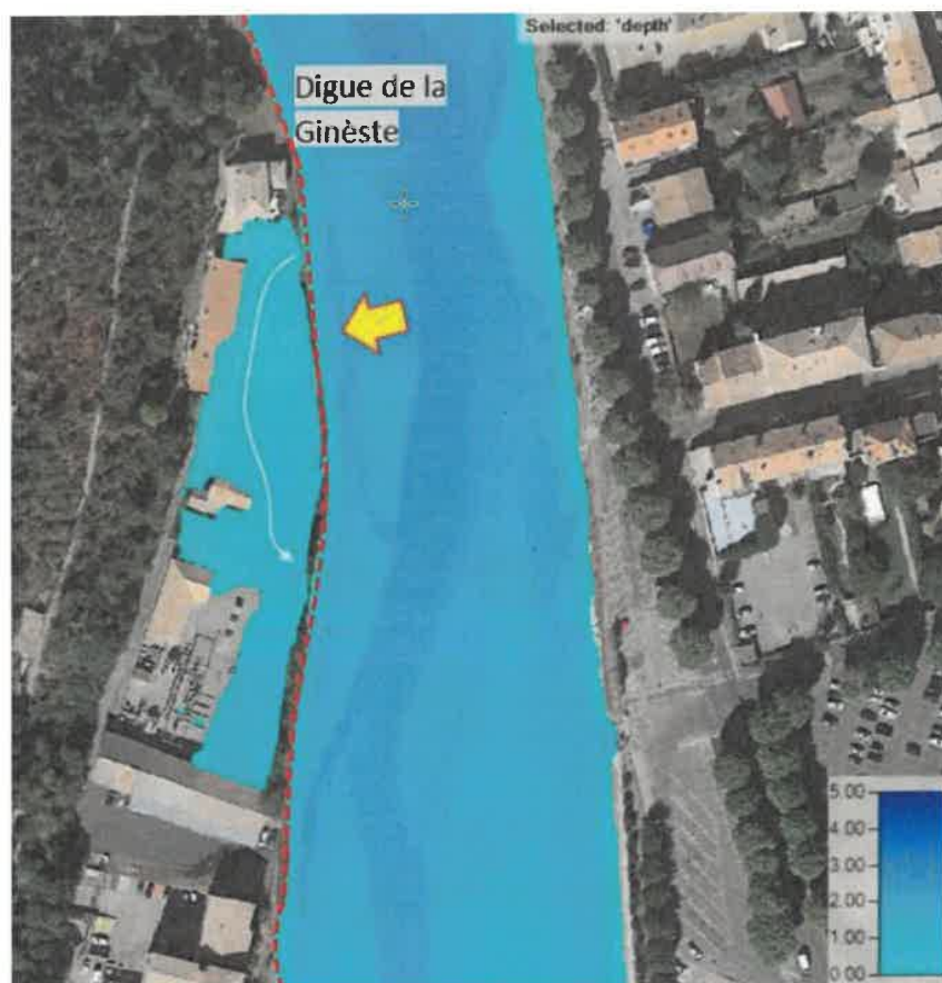
Figure 8 : Hauteurs d'eau maximales en mètres sur la zone de débordement en Q50 au niveau de la digue de la Gineste, secteur Bléone rive droite.
