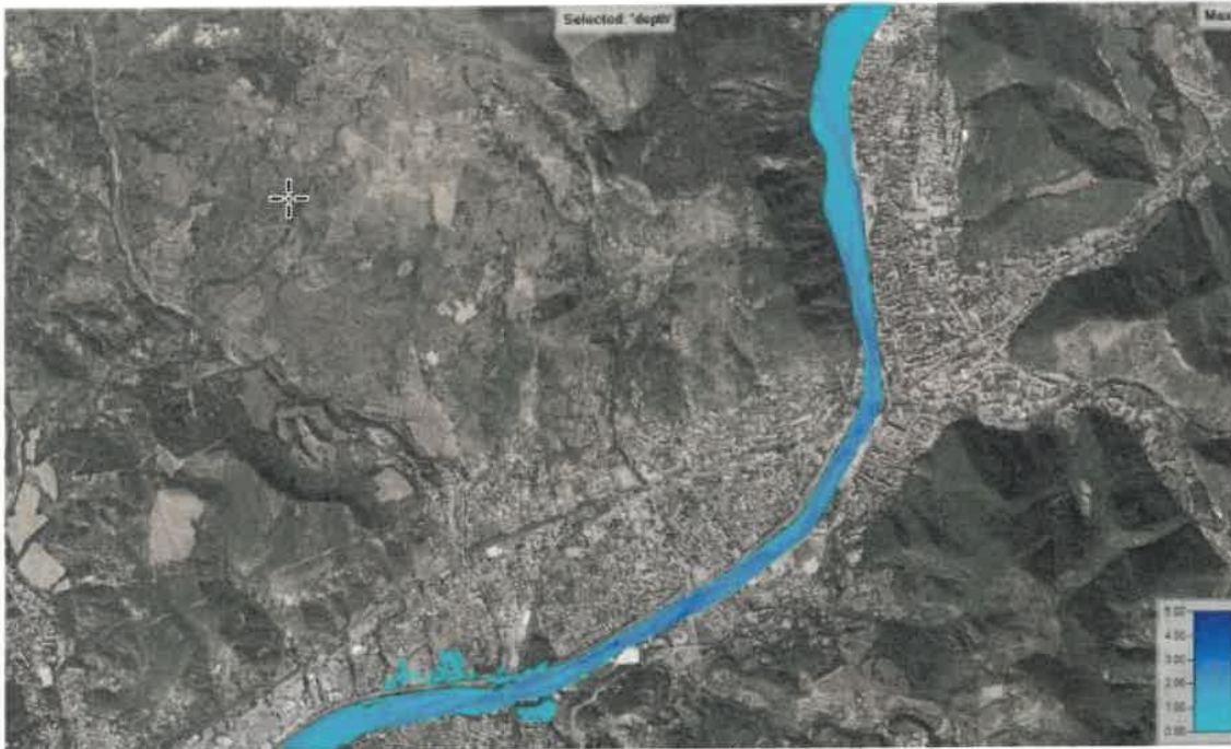
Figure 15: Hauteurs d'eau maximales (m) dans le scénario 4
