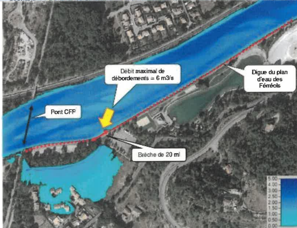
Figure 14 : Scénario 4 : hauteurs d'eau maximales en mètres - Q100 et brèche dans la digue du plan d'eau des Ferréols
