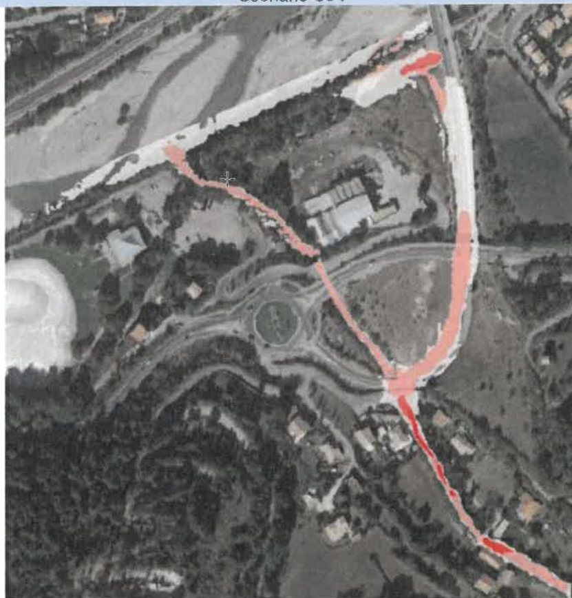
Figure 42: Zones dangereuses (rouge foncé et rouge clair) et zones non dangereuses (blanc)– scénario S9 – secteur du plan d'eau des Ferréols, amont.
